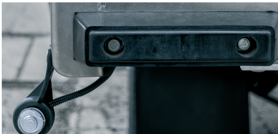
Hinterer Rammpuffer zum Schutz des Rahmens.
